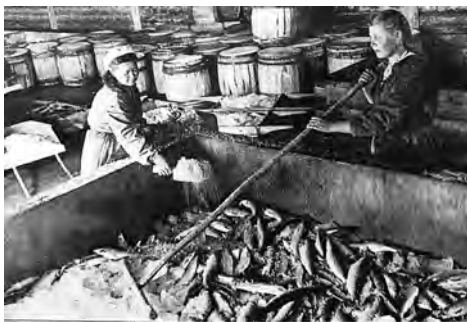
Рис. 1.24. Таинство посола: чановая засолка омуля. Бетонный (слева) и деревянный чаны для посола. Деревянный чан высотой 1,5 м, верхний диаметр 1,3 м, нижний – 1,7 м вместимостью 1 т омуля (1940-е гг.)
