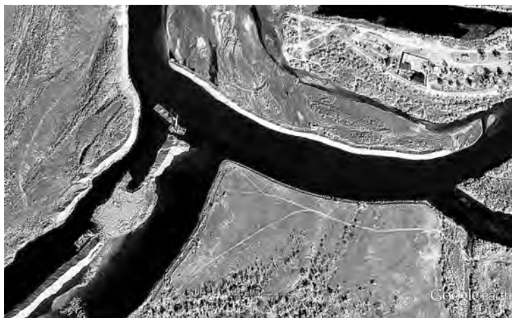
Рис. 6.6. Русловая разработка песчано-гравийных материалов на р. Селенге на 155-м км от устья (космоснимок Google Earth от 29 августа 2009 г. во время нерестового хода омуля вверх по реке)
