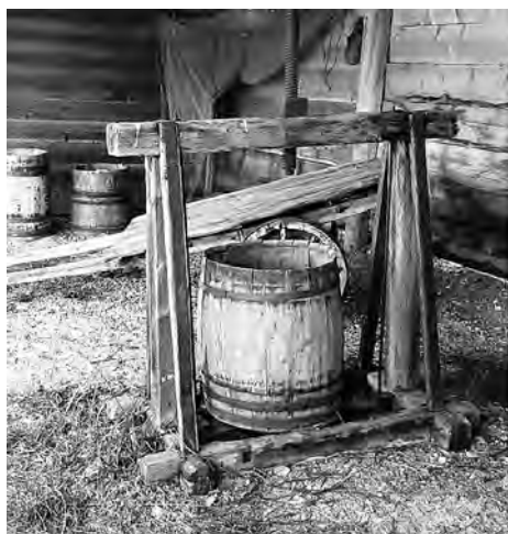
Рис. 1.43. Прессы для укладки просолившегося омуля в бочки (фото А. В. Базова из музея «Тальцы» и альбома Кабанского рыбозавода)
