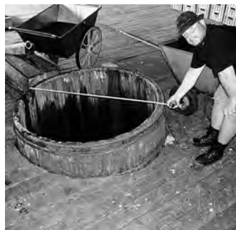
Рис. 1.24. Таинство посола: чановая засолка омуля. Бетонный (слева) и деревянный чаны для посола. Деревянный чан высотой 1,5 м, верхний диаметр 1,3 м, нижний – 1,7 м вместимостью 1 т омуля (1940-е гг.)
